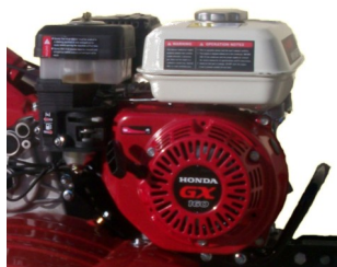
FILTRO DE AIRE EN BAÑO DE ACEITE. MOTOR HONDA GX160 5.5CV
