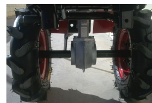
DETALLE RUEDAS 400 X 8 CON BUJE INCLUIDO
